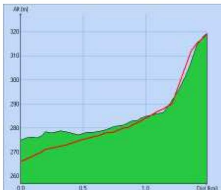
Le profil en long du tracé sélectionné pâtit de ces interpolations, il constitue cependant un outil de travail pratique pour rechercher les points hauts et les points bas.
