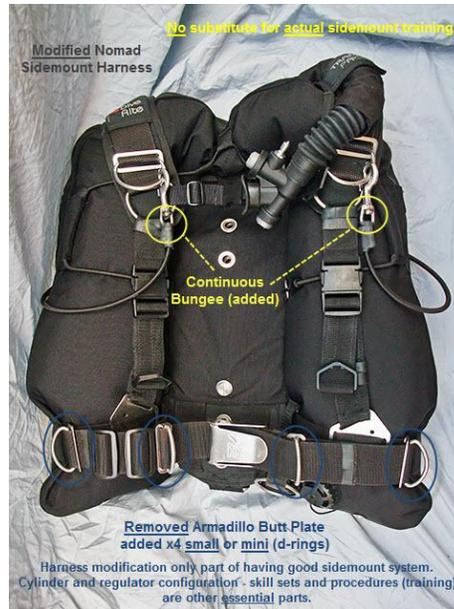
On peut observer aussi l'élimination de la « queue de castor » ou « but plate » : en effet, cet élément a un côté pratique pour fixer les blocs sur les fesses du plongeur, mais cela entraîne aussi plus de poids sur la partie basse du corps, qui tend à faire « tomber » les jambes, et complique le bon maintien du trim !
