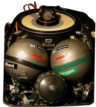
Les tests indiquent, que dans les conditions indiquées, l'absorption fonctionne correctement pendant 2h à 3h selon les filtres et pour une capacité de 2,5kg d'absorbant. Au-delà de ces durées, une partie significative de CO<sub>2</sub> traversera le filtre sans être piégé par la chaux. Mais que se passe-t-il aux autres profondeurs.
