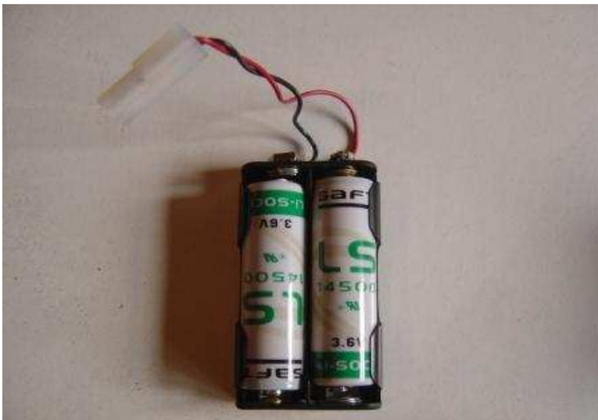
3 \* A partir d'un collage de 2 piles de + gros ampérage et un peu de soudure
